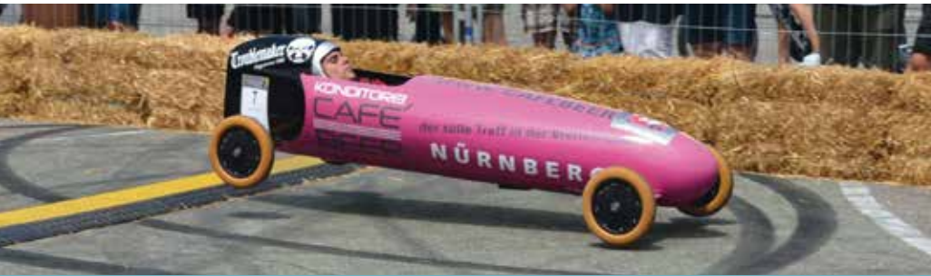
Aerodynamisch: Eine zigarrenförmige Seifenkiste aus Carbon und Glasfaser hebt ab. Bild: Zeuner
