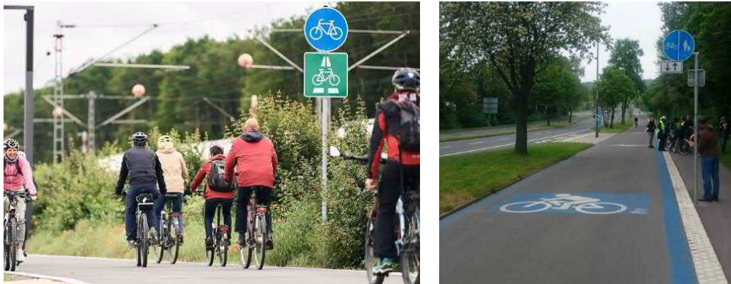
Abbildung 59: Beispiele für Beschilderung / Markierung von Radschnellverbindungen 33
